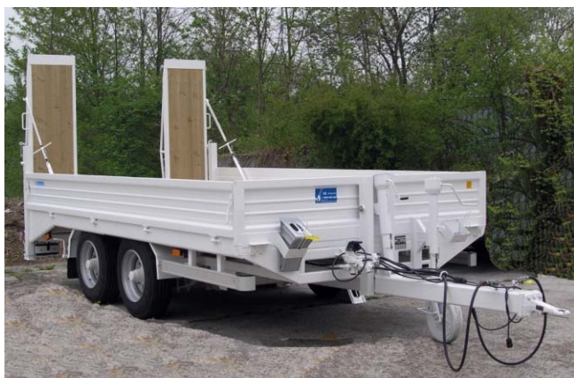
Össztömeg: 6900 kg , rendelésszám: 651/6900, Terhelhetőség kb. 4950 kg, rakfelület kb.4500*2450 mm, Plató magasság: kb.850mm
