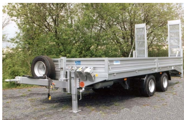
Össztömeg: 18000 kg , rendelésszám: 688/18000, Terhelhetőség kb.13900 kg rakfelület kb.6200*2450 mm, plató magasság: kb.980 mm,8 kerékkal , állítható vonófejjel
