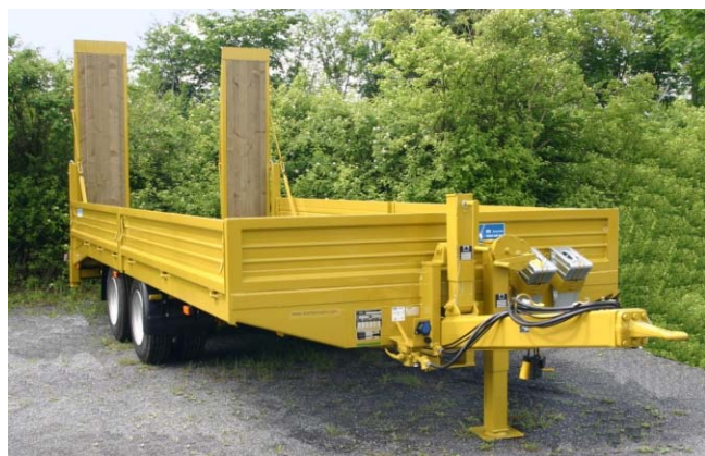
Össztömeg: 13800 kg , rendelésszám: 682/13800, Terhelhetőség kb. 10500 kg rakfelület kb.5000*2450 mm plató magasság: kb.900 mm, 8 kerékkal
