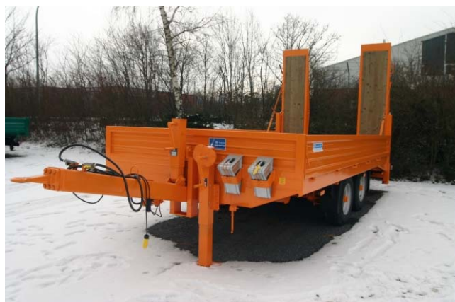
Össztömeg: 8900 kg , rendelésszám: 652/8900, Terhelhetőség kb. 6800 kg, rakfelület kb.5000*2450 mm Plató magasság: kb.850mm
