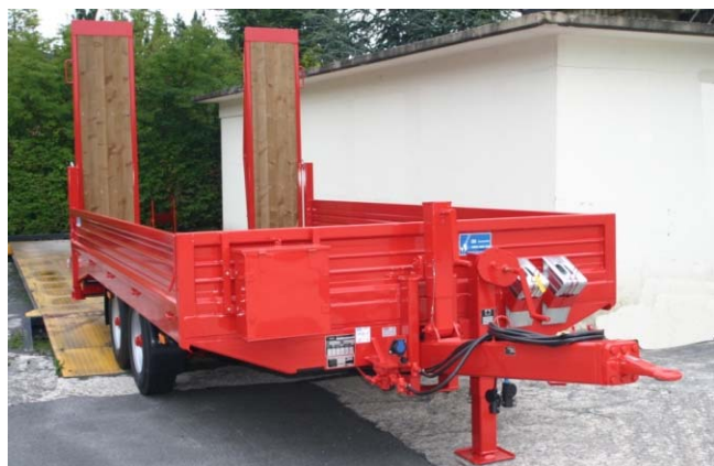
Össztömeg: 10500 kg , rendelésszám: 663/10500, Terhelhetőség kb. 7900 kg, rakfelület kb.5000*2450 mm, Plató magasság : 880 mm, 4 kerékkal, szerszámosládával Össztömeg 10500 kg , rendelésszám : 672/10500, 8 kerékkal
