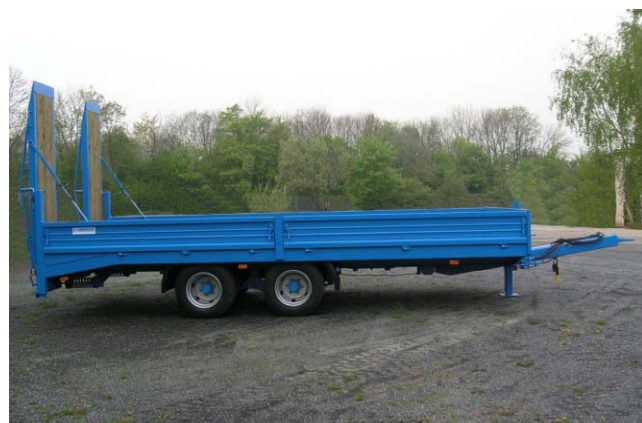
Össztömeg: 11900 kg , rendelésszám: 664/11900, Terhelhetőség kb. 9300 kg rakfelület kb.5000*2450 mm plató magasság: kb.880mm, 4 kerékkal Össztömeg: 11900 kg , rendelésszám: 674/11900, 8 kerékkal
